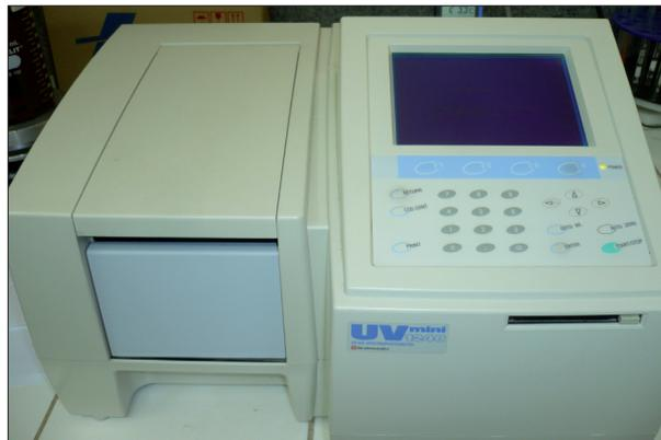
Figura 4. Espectrofotômetro Shimadzu UV Mini 1240.
