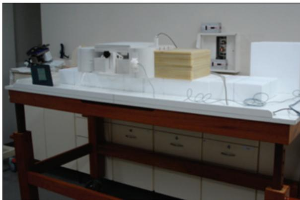
**Figura 1.** *Setup* de irradiação de corpo inteiro para calibração do diodo.
