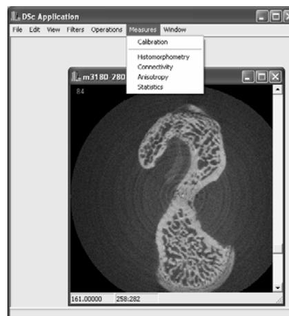
Figura 3. Interface do programa de quantificação juntamente com um exemplo de reconstrução de uma amostra de fêmur de rato Wistar.
