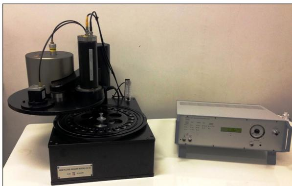
**Figura 1.** Leitora RISØ TL/OSL, modelo TL/OSL-DA-20.
