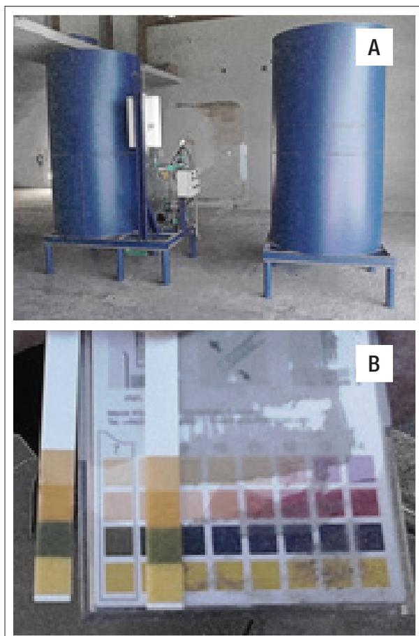
**Figura 2.** (A) Tanques misturadores; (B) Indicadores dos níveis de pH.
