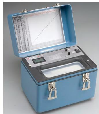
Figura 1. Simulador 1430 LE Mini-Doppler Flow System<sup>7</sup>.
