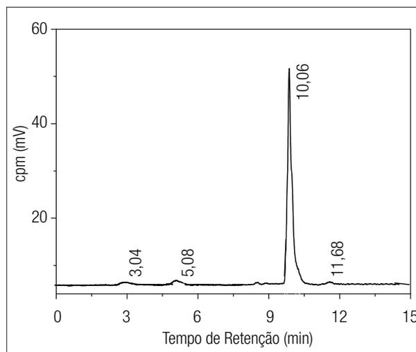
**Figura 2.** Cromatograma de EC-<sup>99m</sup>Tc. Coluna Shim-Pack VP-ODS (250 x 4,6 mm; 5 μm); fase móvel: Na<sub>2</sub>HPO<sub>4</sub> (0,0125 mol L<sup>-1</sup>); C<sub>2</sub>H<sub>5</sub>OH, gradiente linear: 100% fase aquosa a 100% fase orgânica. Fluxo da fase móvel: 1,0 mL min<sup>-1</sup>; volume de amostra: 20 μL.
