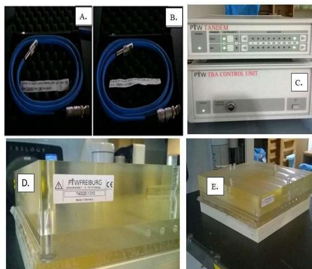
**Figura 2.** (A. y B.) Cámaras de Ionización PTW (C) Fuente y regulador de alto voltaje (D y E) Maniquí PTW IMRT Universal.
