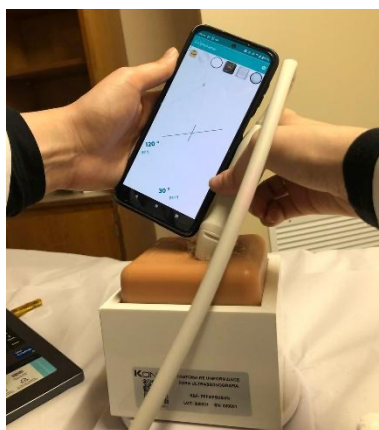
Figura 2 - Exemplo do uso do inclinômetro para quantificar a inclinação, com o dispositivo apoiado diretamente sobre o transdutor para garantir a medição do ângulo.
