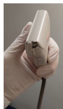
Figura 9: Inspeção visual do transdutor 12 na qual foram detectadas rachaduras estruturais importantes na sonda lateral.
