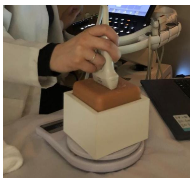
Figura 3 - Coleta de imagens com a pressão quantificada utilizando uma balança digital modelo SF-400, posicionada abaixo do objeto simulador (OS).
