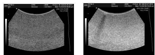
Figura 1: Comparação entre transdutores. 1a: Transdutor conforme (esquerda). 1b: Transdutor não conforme (direita), apresentando artefatos de não uniformidade devido a danos nos cristais piezoelétricos. (8)
