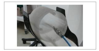
**Figura 2.** Simulador dosimétrico de cabeça no suporte para cabeça de um tomógrafo com um detector no orifício central.
