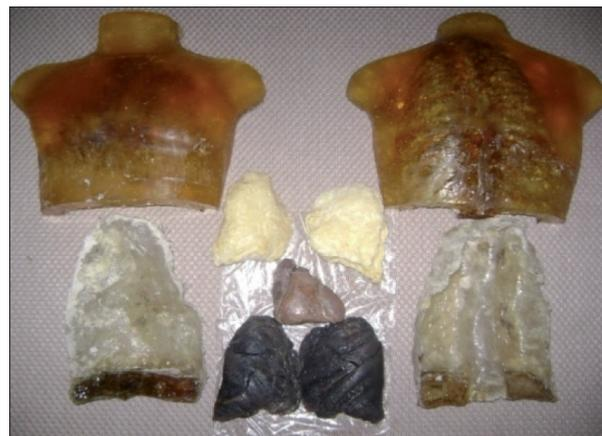
**Figura 4.** Foto do Objeto Simulador Antropomórfico de Tórax bipartido, com diafragma removível, coração real e pulmões artificiais e reais.
