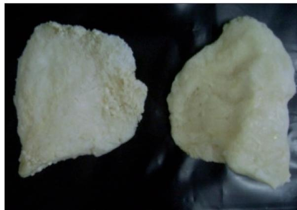
**Figura 3.** Foto dos pulmões artificiais (esquerdo e direito, respectivamente), feitos de espuma de poliuretano.
